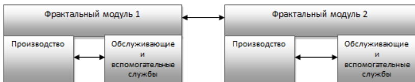
Рис.2 б) Фрактально-модульная структура. Внутренние связи сильнее внешних, число внешних связей сокращается, что обеспечивает целостность структуры, снижаются информационные и управленческие затраты.
